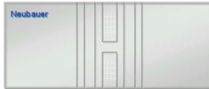
A câmara de Neubauer consiste de uma lâmina de microscopia, bem mais alta do que uma lâmina normal, com marcações em quadrantes, de medidas conhecidas. Observando-se ao microscópio, percebe-se que existem três tipos de quadrantes denominados A, B e C, que juntos formam um quadrado maior.
