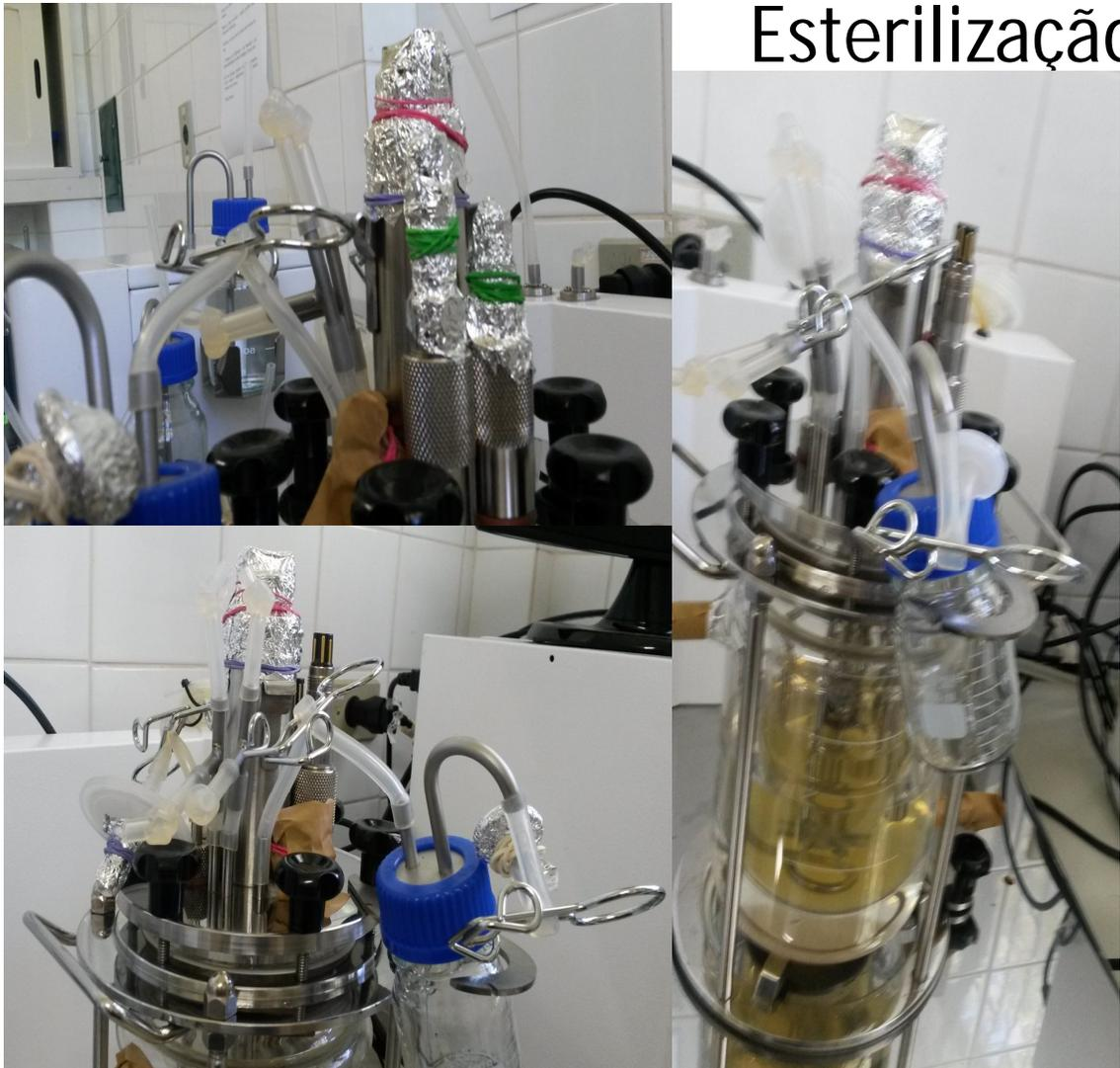
**Figura 16:** Vaso preparado para esterilização por autoclavagem (foto laboratório de bioquímica de microrganismos).
