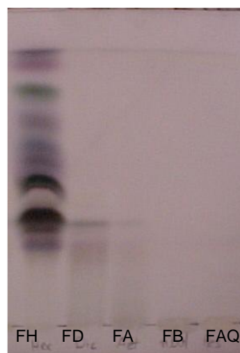
Figura 13: CCD da partição líquido-líquido do EB de C. echinoides eluída com hexano:diclorometano:metanol (6:3:1; v/v) e revelada com anisaldeído sulfúrico.
