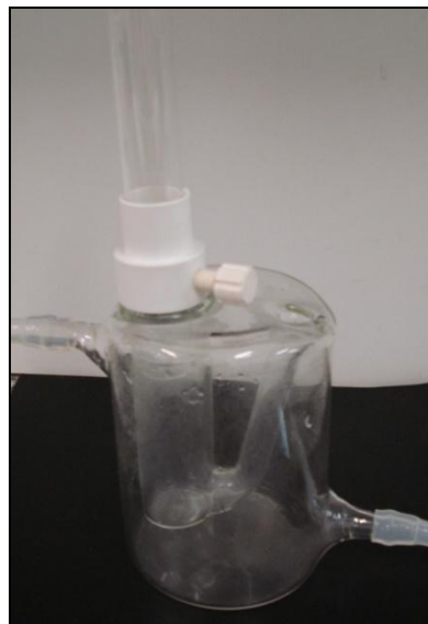
Figura 2.8 – Fotografia de Célula de Difusão de Franz modificada.
