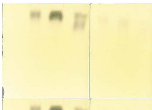
Figura 13 – Cromatograma das 7 subfrações de EPA por CCCAV.
