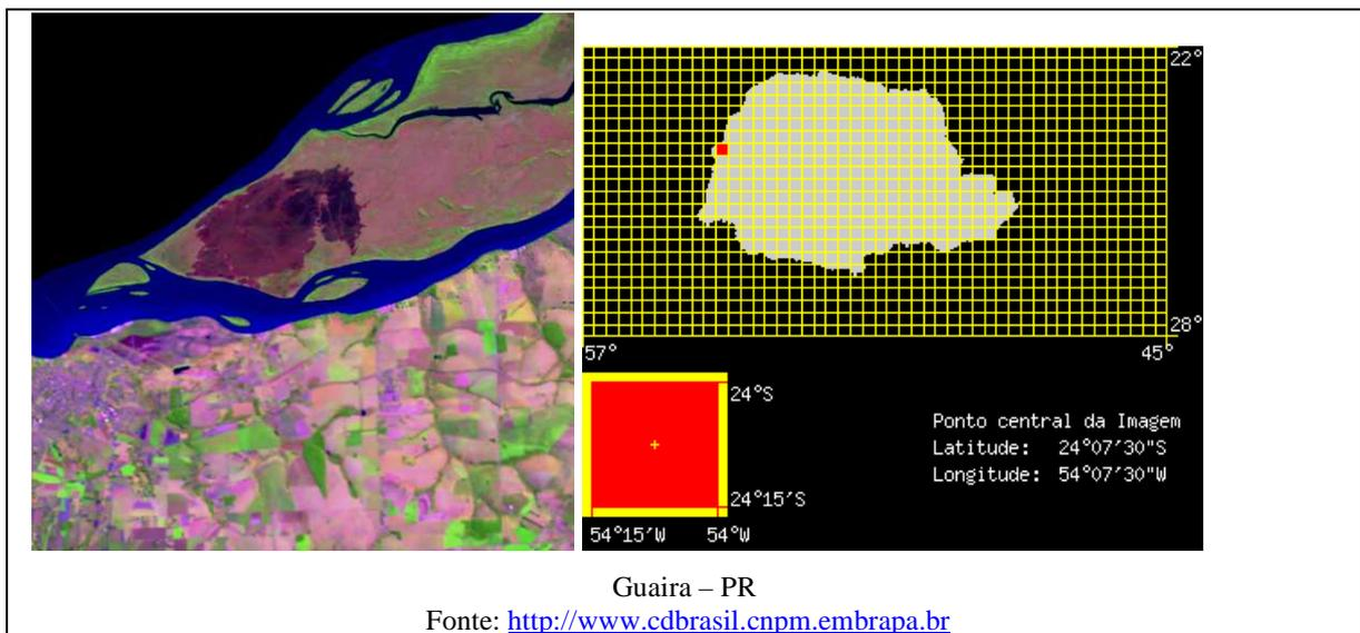
Através dessa imagem é possível obter uma boa aproximação da área da região devastada. Para isso será utilizada uma ampliação em escala de 1 : 25.000, sob uma malha quadriculada de 0,5 cm. Sobre esta malha, construímos um polígono  $P$  com os vértices sobre seus nós, cuja área se aproxima, por excesso, da área da região queimada.
