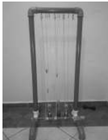
Imagem 2. O experimento das roldanas consiste de duas polias móveis e de duas polias fixas. Esse experimento tem como objetivo mostrar a diferença entre levantar uma determinada massa diretamente e com o auxílio da associação das duas polias móveis.
